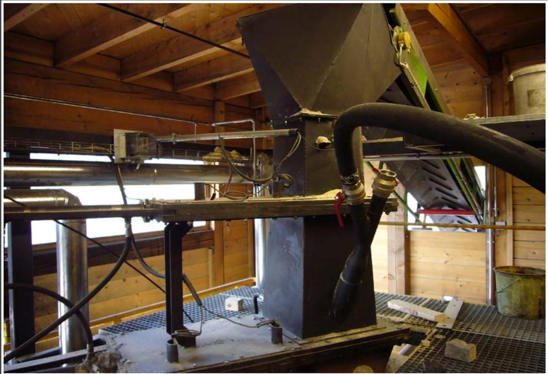
Abbildung 5: Schleusensystem zur Brennstoffaufnahme sowie Reaktorkopf der HVG-Anlage
