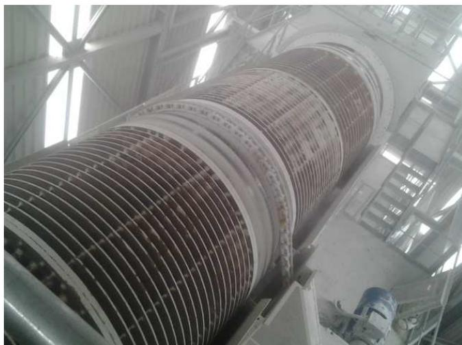
Abbildung 23: Siebtrommel in Betrieb (16.06.2016)
