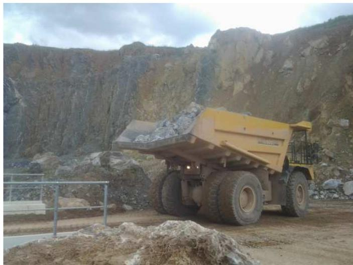
Abbildung 19: Rangieren des beladenen SKW's an die Vorbruchanlage (16.06.2016)
