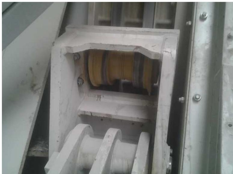
Abbildung 34: Stärkere Laufrollen an der Siebtrommel am 16.06.2016
