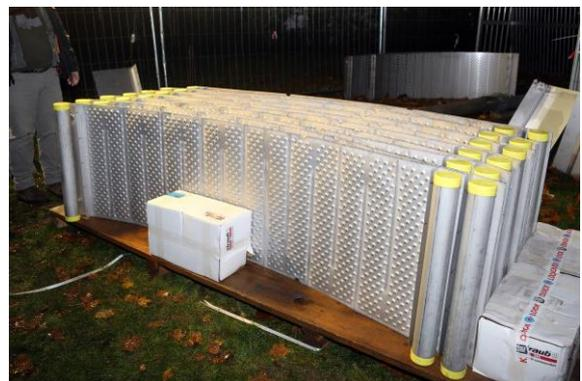
Abbildung 5: links: Installation des Wärmetauschers im Abwasserkanal; rechts: Einzelmodule
