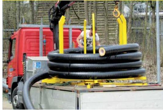
Abbildung 9: Nahwärmeleitung als Doppelrohr
