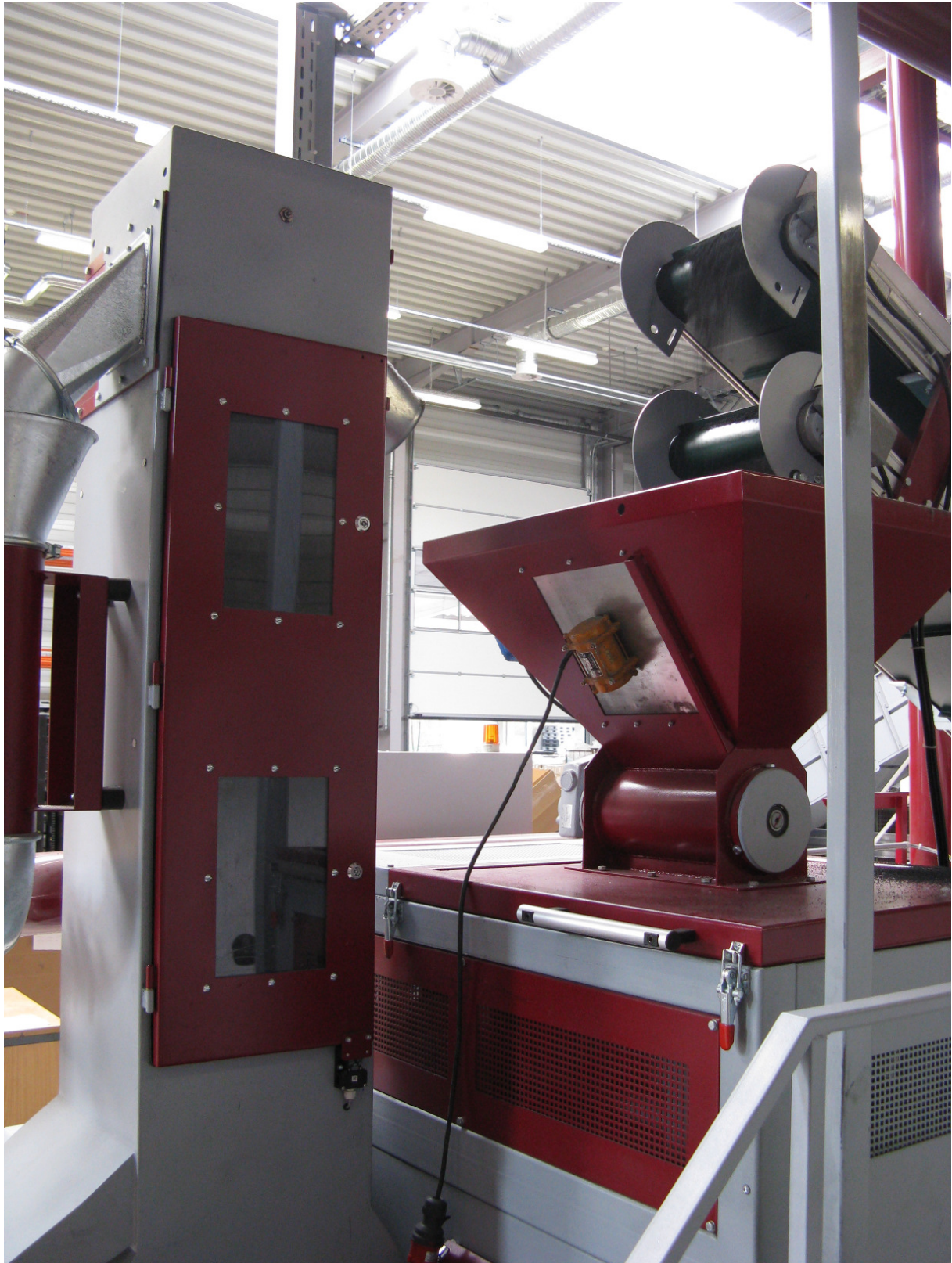
Bild 7: Feinmühle mit Vertikalsiebeinrichtung
