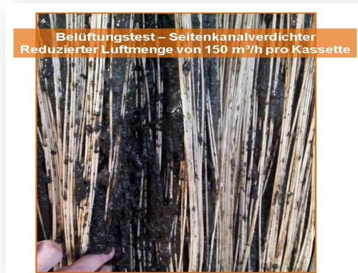
Abbildung 4: GKW Nordkanal – Belüftungstest mit dem Seitenkanalverdichter bei der reduzierten Luftmenge von 150 m 3 /h pro Kasette bei der Air-cycling-Belüftung
