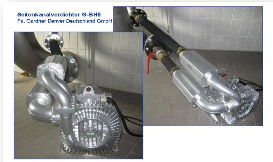
Abbildung 3: Testversuch - Seitenkanalverdichter als Membranbelüfter
