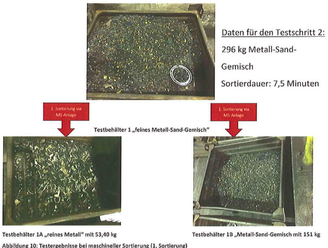
Abbildung 10: Testergebnisse bei maschineller Sortierung (1. Sortierung)
