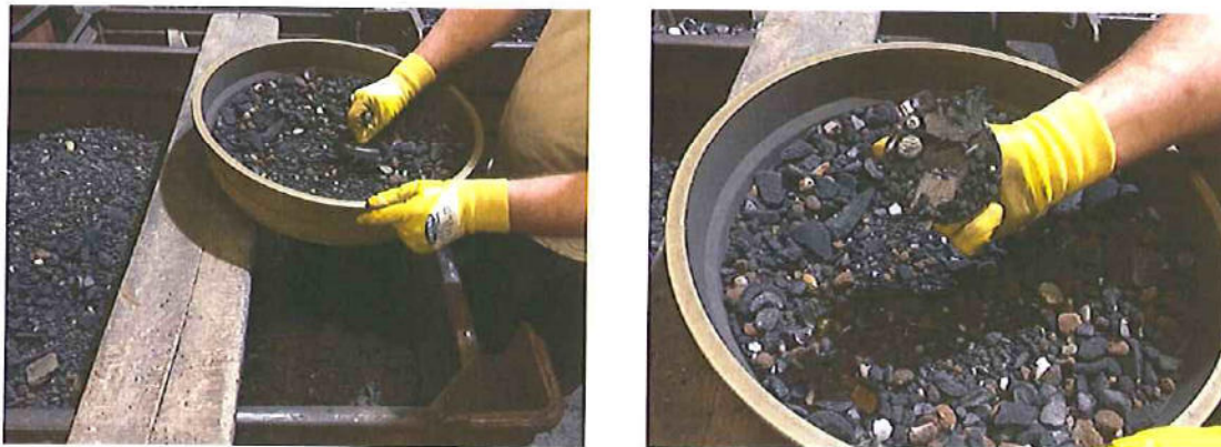
Abbildung 3: Manuelles Sortieren von Metall-Sand-Gemischen mittels Sieb und Magnet in der Eisenwerk Erla GmbH
