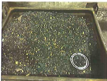
Abbildung 8: Testbehälter 1 („feines Metall-Sand-Gemisch“)
