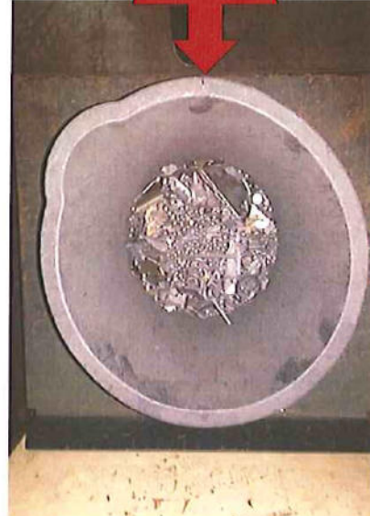
Abbildung 12B: reine Metallbestand (8,60 kg) nach zweiter Sortierung durch MS-Anlage
