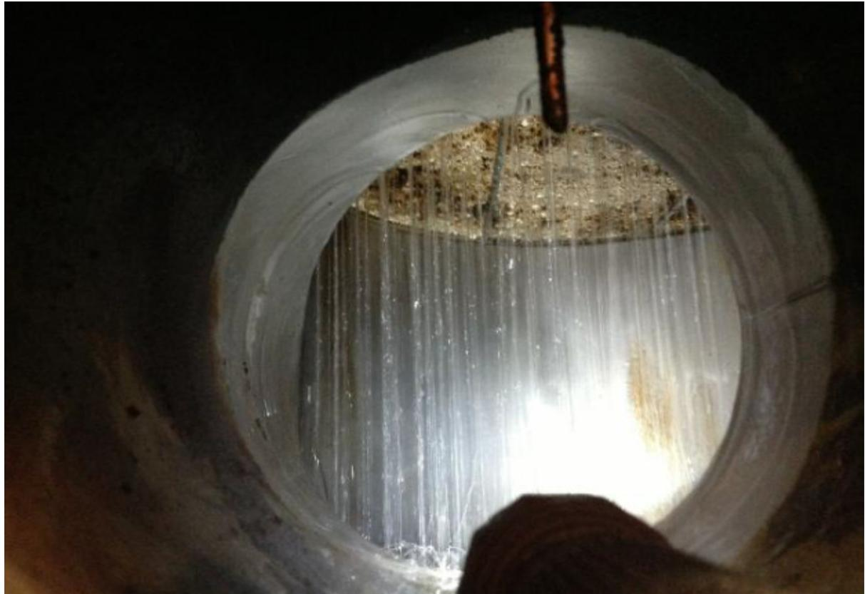
Abbildung 8: Wasserverteilung unterhalb des untersten Pads bei Pumpendrehzahl 40 Hz
