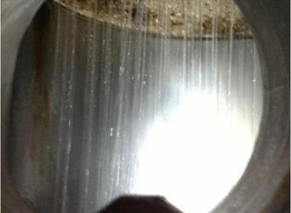
Abbildung 7: Wasserverteilung unterhalb des untersten Pads bei Pumpendrehzahl 30 Hz
