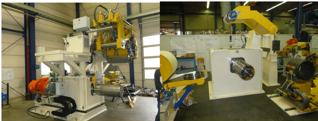
Abbildung 13: Aufwickelhaspel mit Gurtumschlänger zum Anwickeln der Kupferbänder
