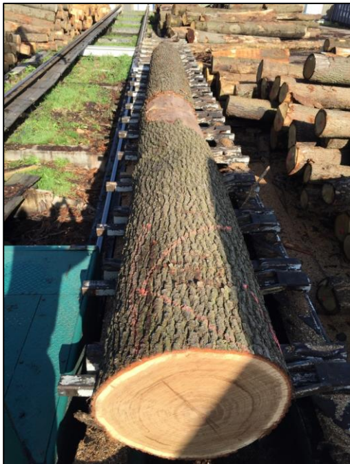
Abb. 39: konische Stammform Eiche mit Riss in der Schnittfläche am Stammfuß
