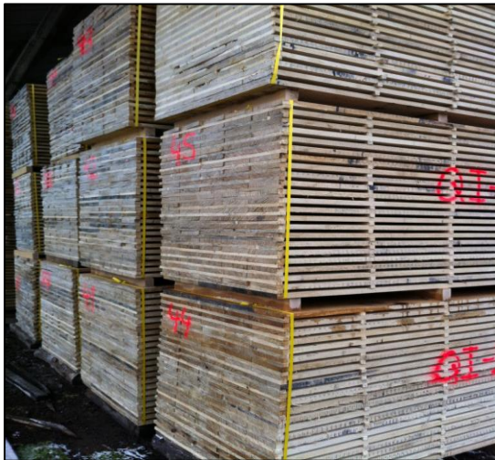
Abb. 13: Schnittholzstapel während der Lufttrocknung
