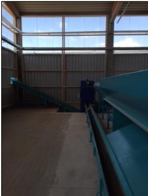
Abb. 34: Förderband für Spreißel zum Restholzhacker
