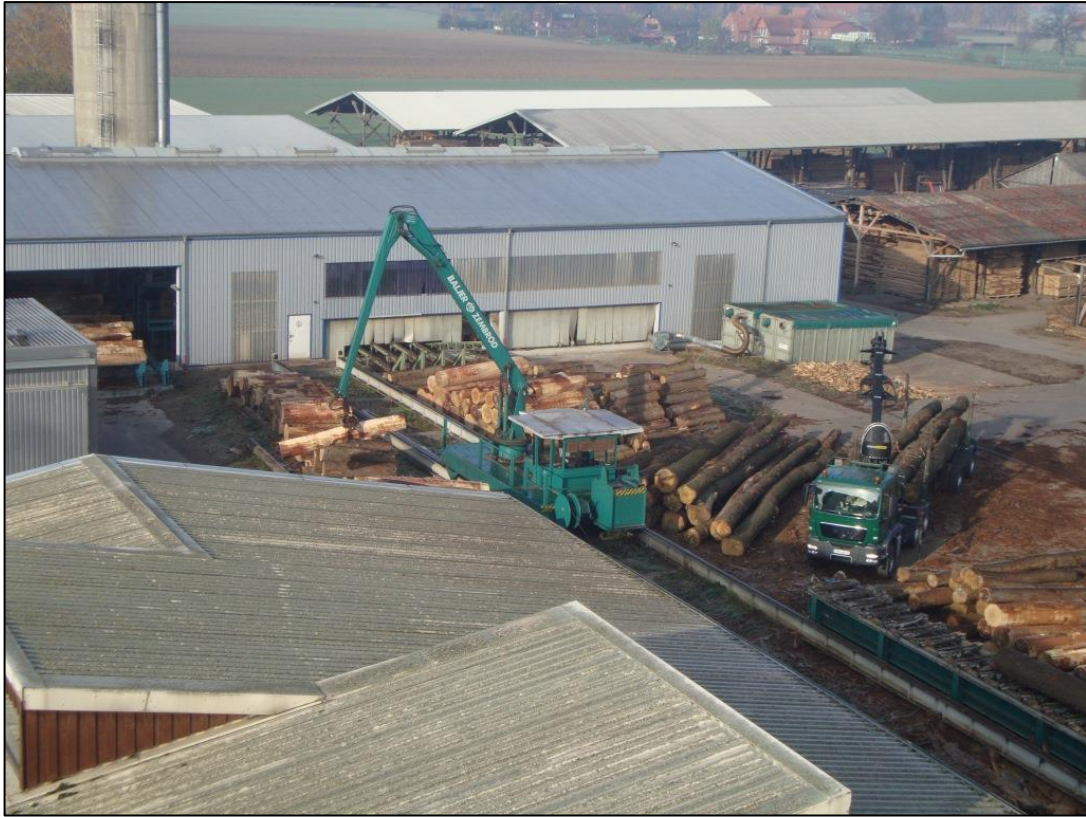
Abb. 4: Rundholzplatz mit Rundholzsortierwagen und Rundholzanlieferung durch einen LKW Im Hintergrund ist die Sägehalle zu sehen
