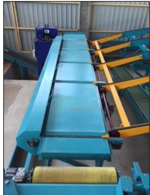
Abb. 35: Abziehtisch mit Querfördermitnehmer zur Trimmsäge
