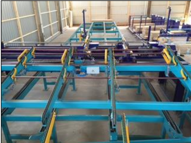
Abb. 37: Übergabe Trimmskappsäge zum Pufferförderband und Anschluss der Absaugung
