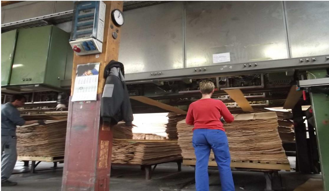
Abb. 5 automatische Furniersortierung (Oberband)
