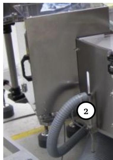
**Abbildung 3 (1) Seitenkanalverdichter | (2) Anschluss an die Gebläsedüse**
