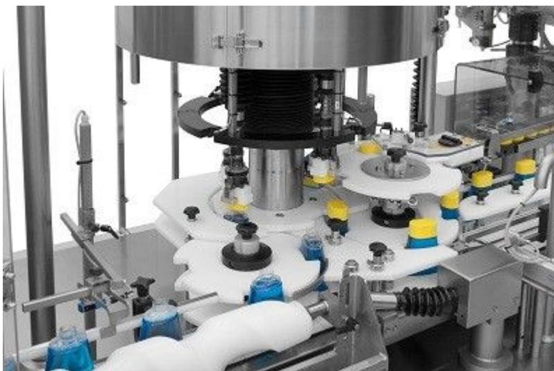
**Abbildung 5 Rundverschließmaschine der Breitner Abfüllanlagen GmbH**
