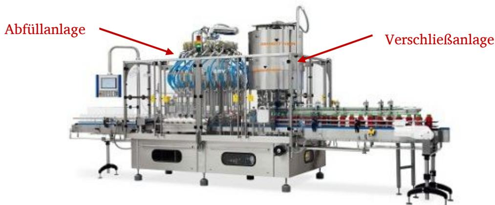
**Abbildung 4 Abfüll- und Verschließanlage in Monoblockbauweise der Breitner Abfüllanlagen GmbH**
