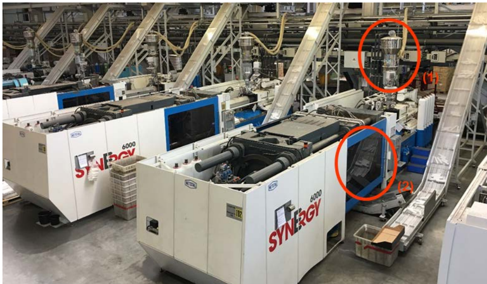
Abbildung 5: Spritzgussprozess zur Herstellung der Rohkartuschen
