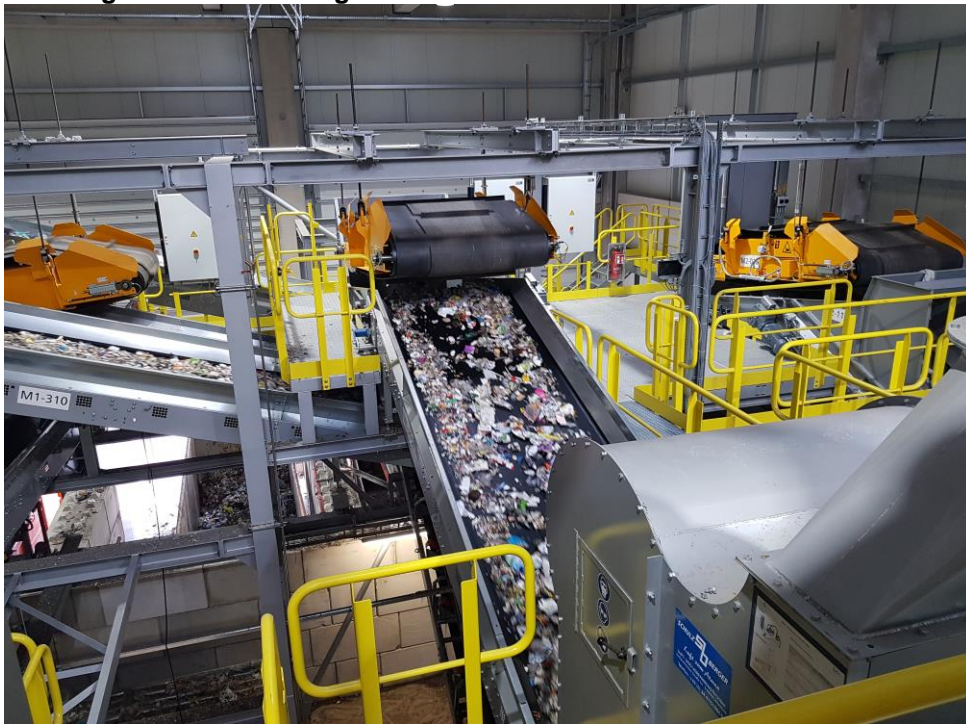
Abbildung 11: Überbandmagneten zum Abtrennen der Eisenmetalle
