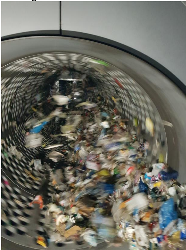
Abbildung 8: Siebtrommel zum Sortieren nach Größe
