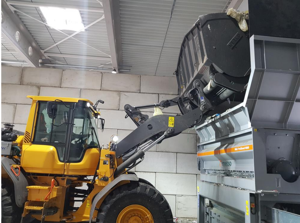
Abbildung 5: Radlader befüllt Vorzerkleinerer
