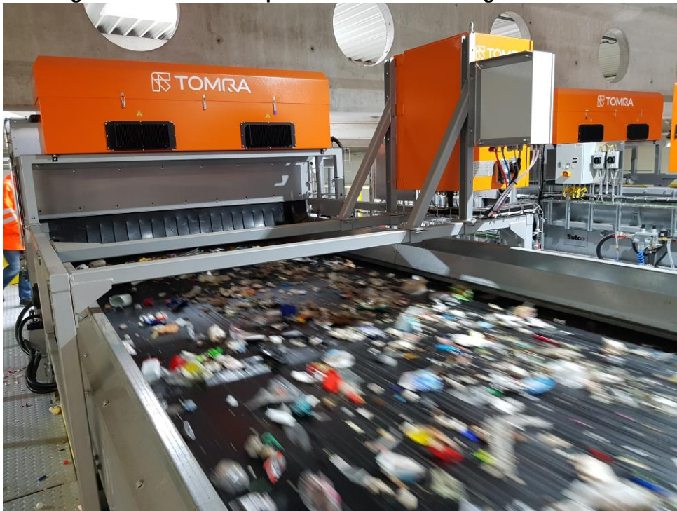
Abbildung 13: NIR-Trenner zur pneumatischen Trennung der Stoffströme
