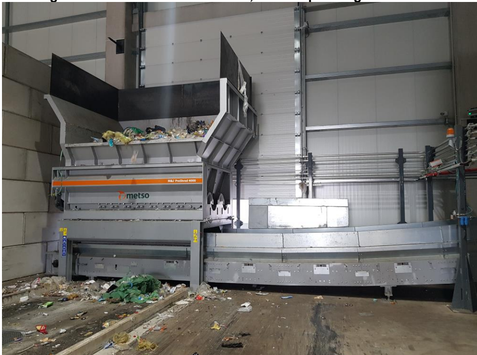
Abbildung 6: Vorzerkleinerer mit Material, davor Inputwaage zum Erfassen des Durchsatzes
