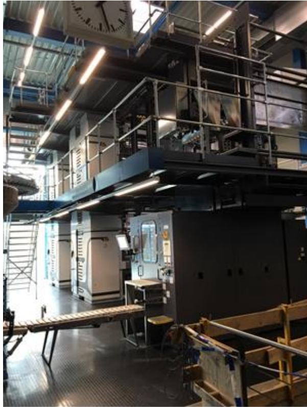
Abbildung 25: Innenansicht OG, Bild der Druckmaschine 2 Druckwerke und 1 Falzapparat
