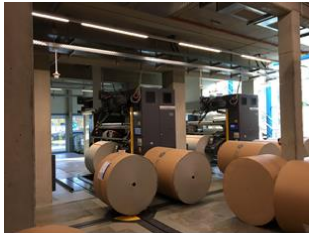
Abbildung 26: Innenansicht UG, 2 Rollensterne unter dem Betontisch; im Vordergrund die zu verdruckenden Zeitungspapierrollen
