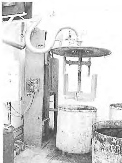
Abb. 6: Bürstenwaschanlage zur Innenreinigung der mobilen Behälter Bei der Reinigung wird gewöhnlich jeweils eine Einheit für die wasserbasierenden und eine Einheit für die lösemittelbasierenden Systeme eingesetzt.
