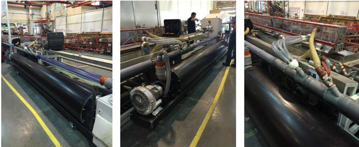
Abbildung 18: Testaufbau Wasserkreislauf und Wassertank
