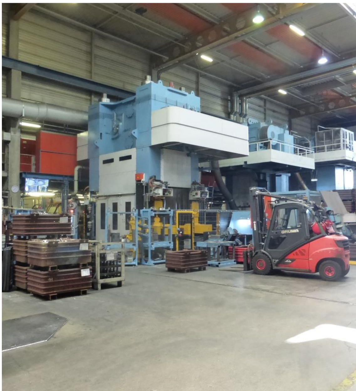
Bild 14: komplette Halbwarm- Umformungsanlage mit Servo-Direkt-Technologie
