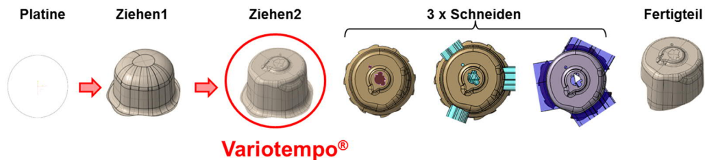
Abbildung 2: Prinzip der zweistufigen Umformung eines Federtopfs (Variotempo®)
