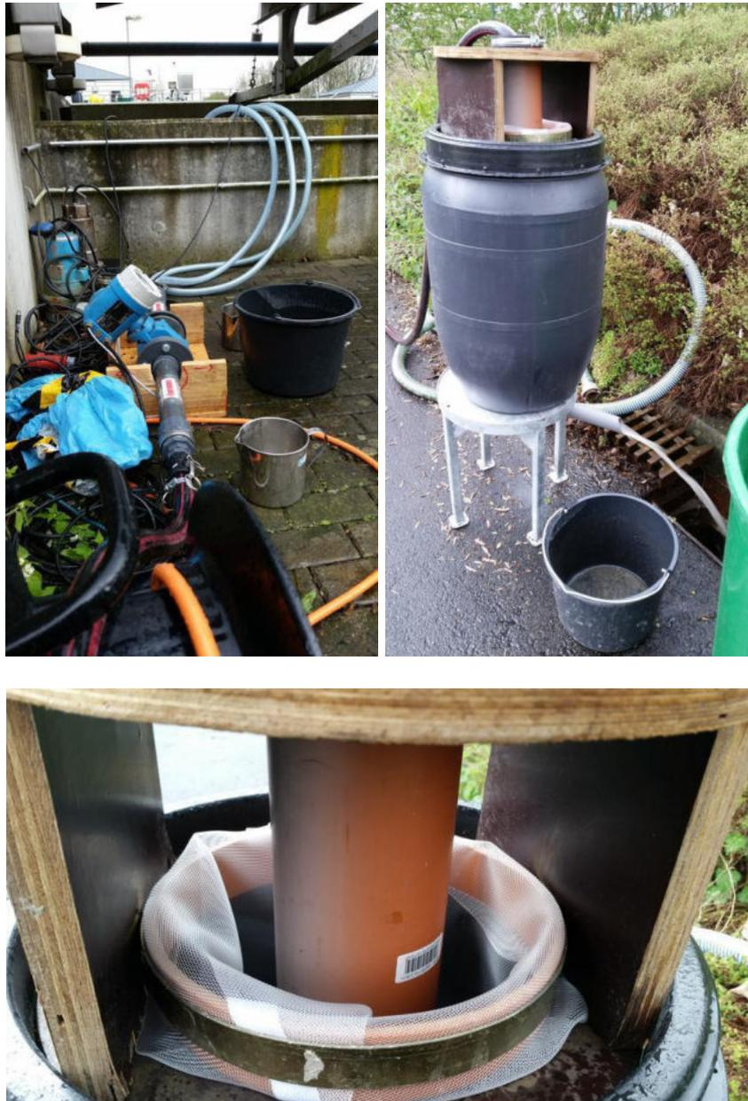
Abbildung 27: kontinuierlicher Probenahmebetrieb mit Filtrationssock
