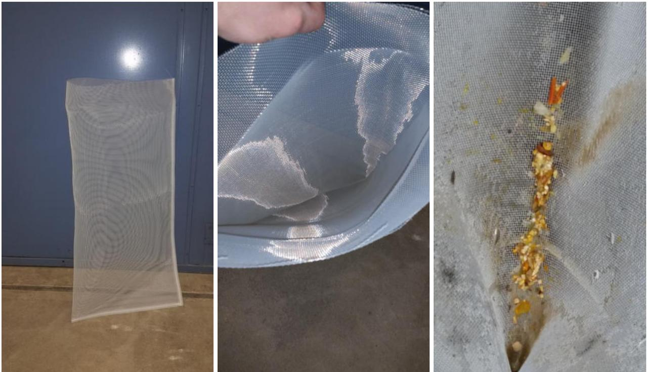
Abbildung 26: Filtrationssack mit 1,0 mm Maschengemetrie
