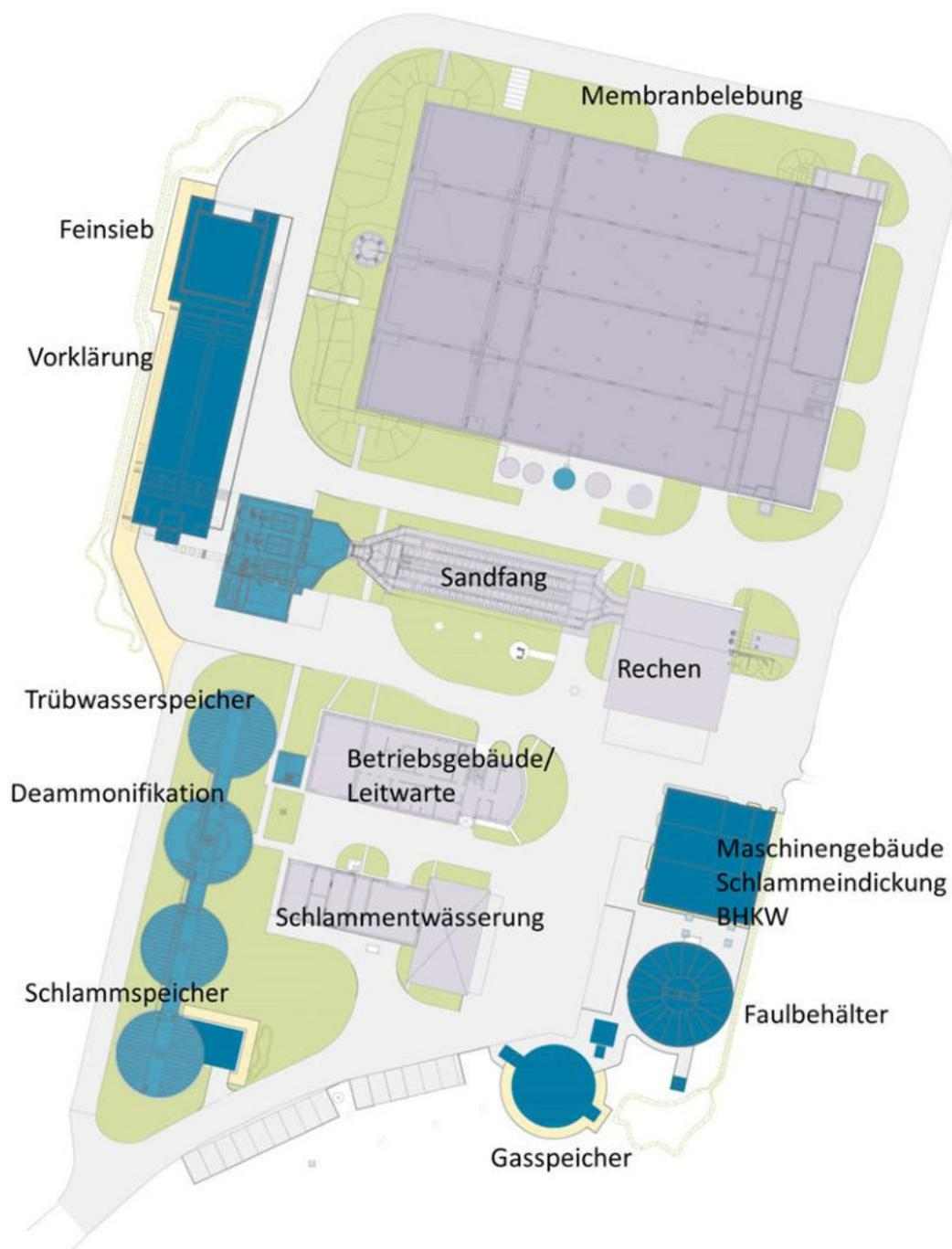
**Abbildung 14: Lageplan der erweiterten Membranbelebungsanlage Nordkanal, neu errichtete Bauwerke sind dunkelblau dargestellt**
