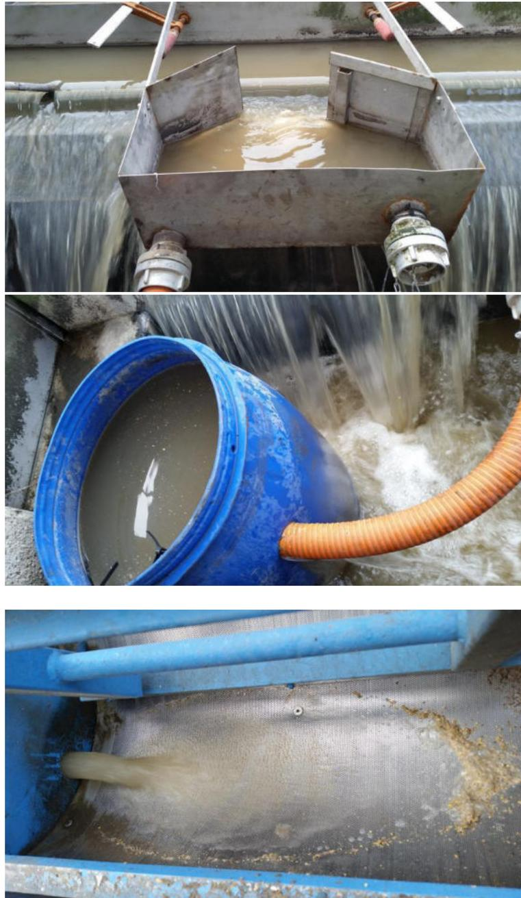
Abbildung 10: Beschickung des Muldensiebes
