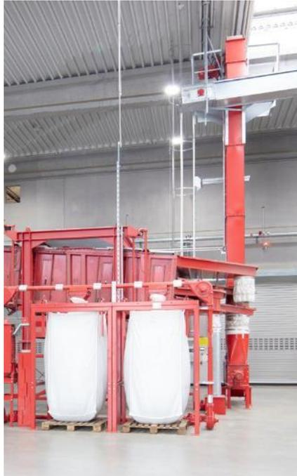
**Abbildung 8:** Nach der Fremdstoff- und Metallabscheidung gelangt das Material auf das Rütteldeck zur Absiebung von Über- und Unterkorn – Über- und Unterkorn werden getrennt gesammelt.
