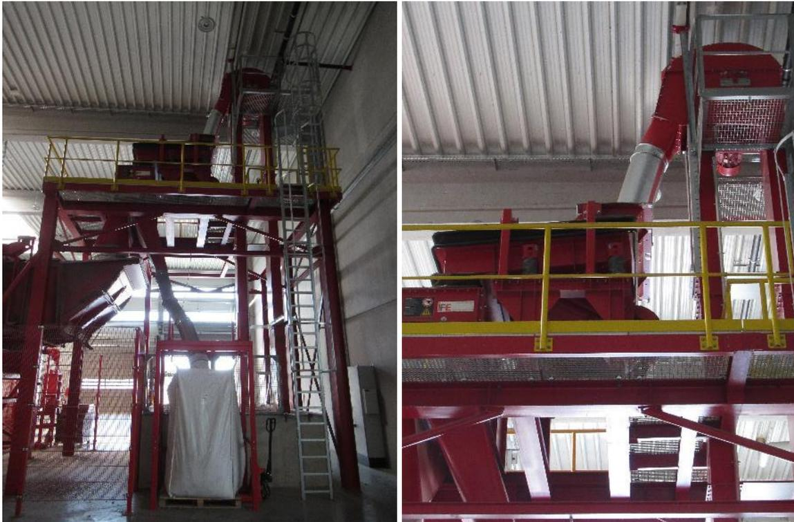
**Abbildung 7:** Metallabscheidevorrichtung in der Gesamtansicht (links) – das Material wird aus dem Bunker nach oben in den Metallabscheider (rechts) gefördert, metallische Verunreinigungen werden aussortiert und unten im BigBag gesammelt
