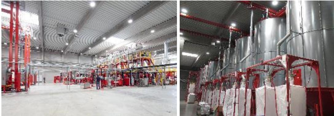
**Abbildung 12:** Gesamtansicht auf die vier Compoundierlinien (links), Tagesmischsilobatterie (rechts)
