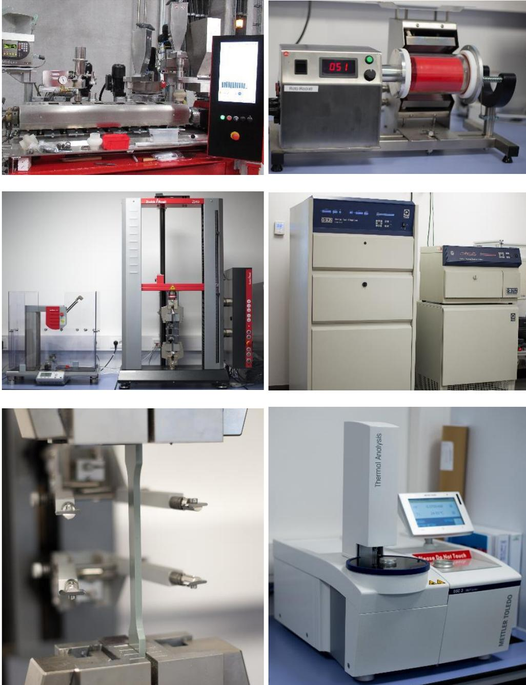
**Abbildung 13:** Laborextruder (oben links), Rotations-Laborgerät (oben rechts), Pendelschlag- und Zugprüfungsgeräte (Mitte links), Lagerschrank bzw. Klimakammer für Prüfkörper mit Normklima (Mitte rechts), Zugprüfung am Prüfstab (unten links), Analysegerät für dynamische Differenzkalorimetrie (unten rechts).
