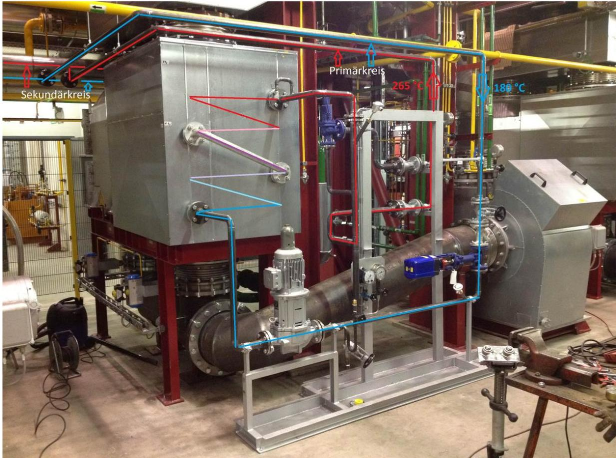
Abb. 6: Thermalölfluss zwischen Thermalölkreislauf (Sekundärkreis) und Sockelkreisläufen (Primärkreis),
