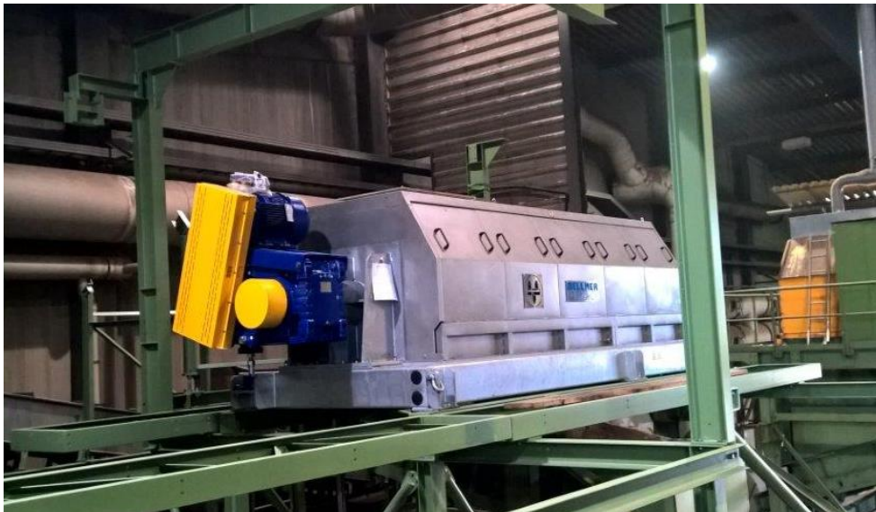
Abb. 5: Schneckenpresse der Fa. Bellmer-Kufferath
