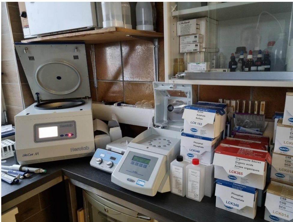
Abbildung 14: Laboreinrichtung für Biogasanlage
