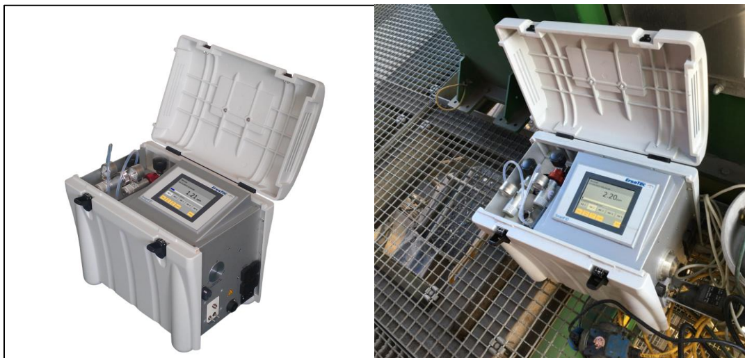
Abbildung 18: Smart FID-Messgerät Fabrik Ersatec 18 sowie Messbetrieb am Shredder
