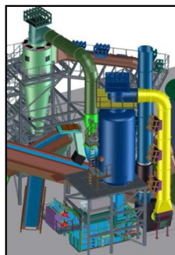
Abbildung 5: Ansicht einer konventionellen Nassentstaubung (Zyklon-grün; Venturidüse-hellgrün; Tropfenabscheider-blau) 12
