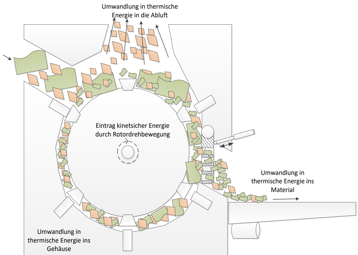
Abbildung 7: Energetische Vorgänge in der Mühle
