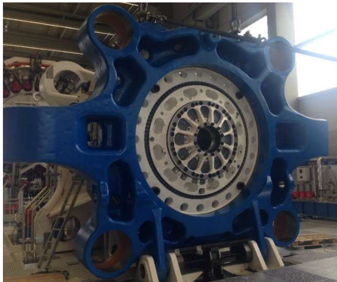
Abb. 7: Anbindung des „Testlagerpaketes“ mit dem Prüfstand
