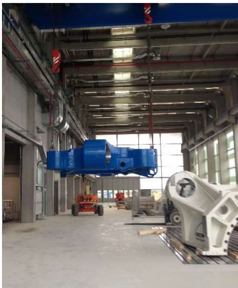
Abb. 4: Montage der Gehäuseteile des Prüfstands (links), Montage der Antriebswelle (rechts)
