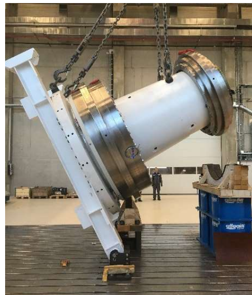
Abb. 4: Montage der Gehäuseteile des Prüfstands (links), Montage der Antriebswelle (rechts)
