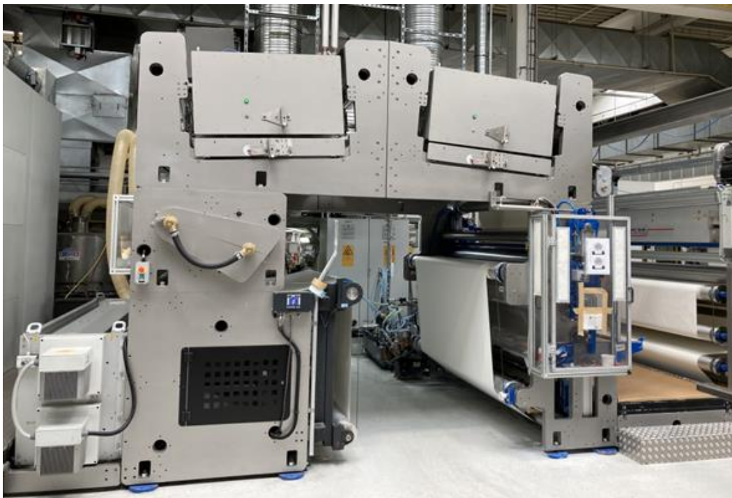
Abbildung 9: NIR-Trocknereinheit nach der Primerung
