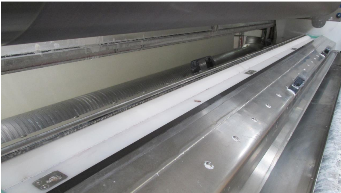
Abbildung 8: Kammerrakel im direkten Auftragsverfahren
