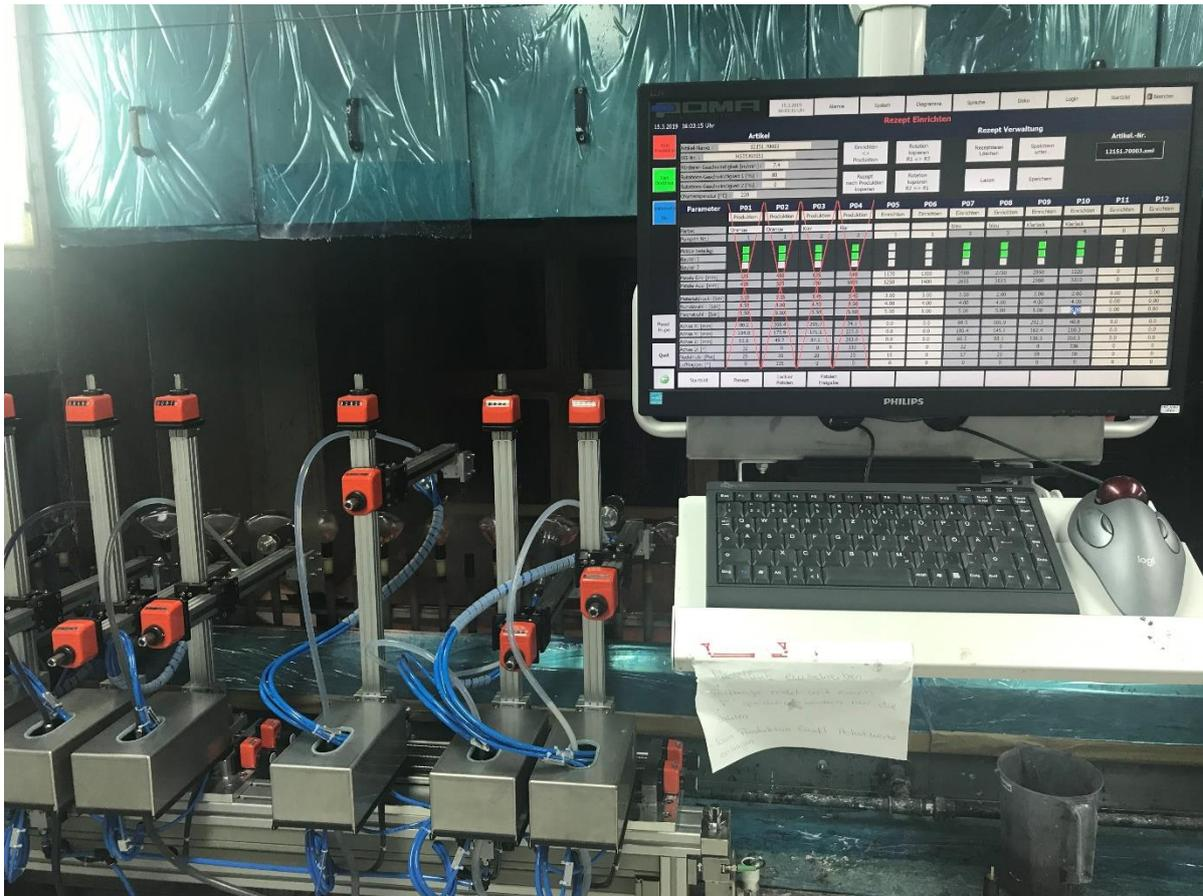
Abbildung 6: Anlage zur Einstellung der Sprühpistolen mit Monitor, Bild 1
