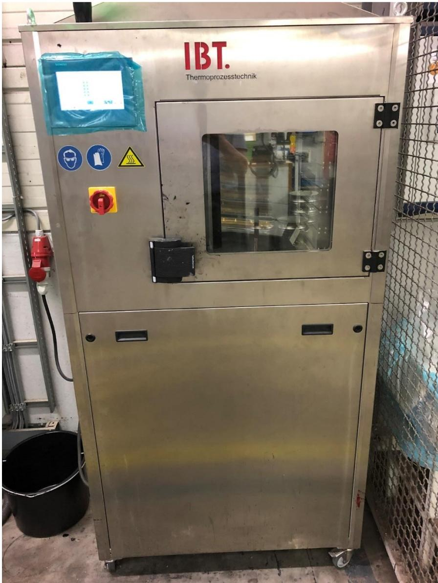
Abbildung 8: IR-Kammerofen zur Trocknung der Musterflaschen
