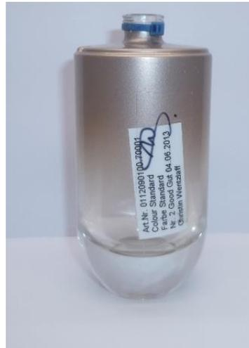
**Abbildung 1: (links) Glasflakons werden besprüht (rechts) Glasflakon mit Farbverlauf**
