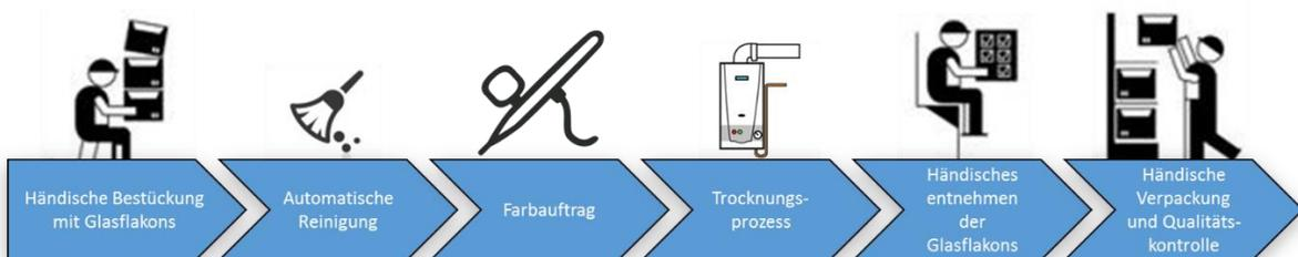
**Abbildung 2: Schematische Darstellung des Veredelungsprozesses von Glasflakons**
