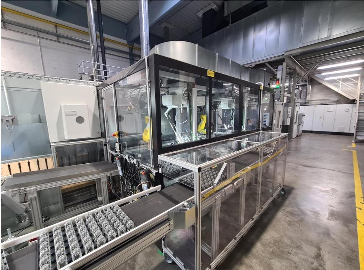
Abbildung 3: Roboter-Anlage zur Bestückung, Bild 1
