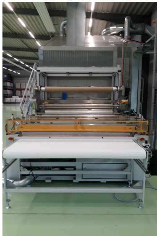
Abbildung 15 - Schneidanlage und Wickeleinheit nach dem Trockner, Foto Gelinova
