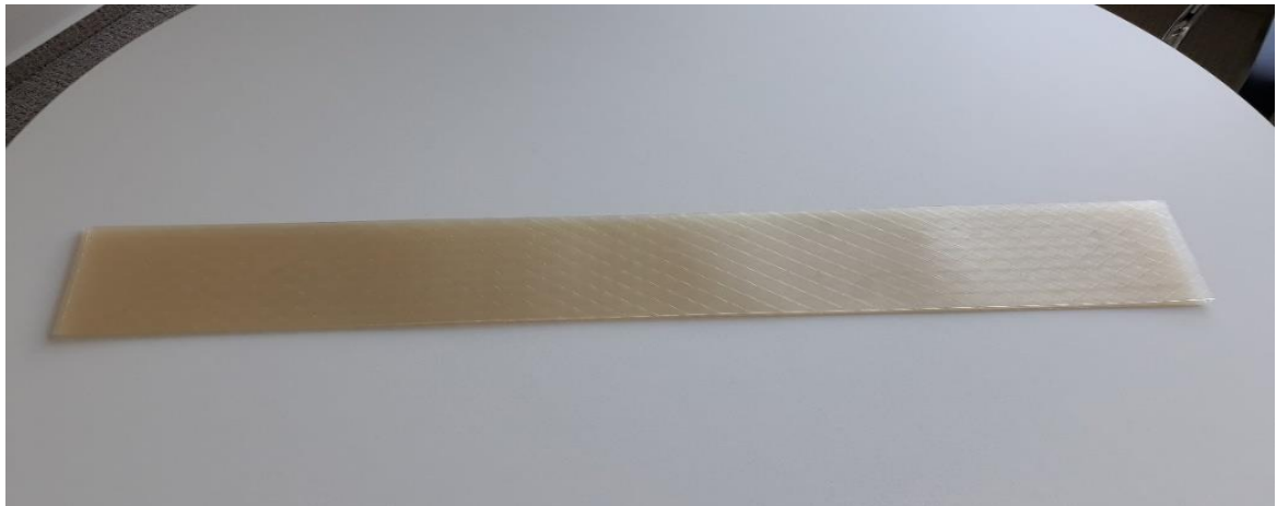
Abbildung 23 - geschnittene Formate (77 cm x 11,5 cm) für die Schneidanlage Kleinformate, Foto Gelinova
