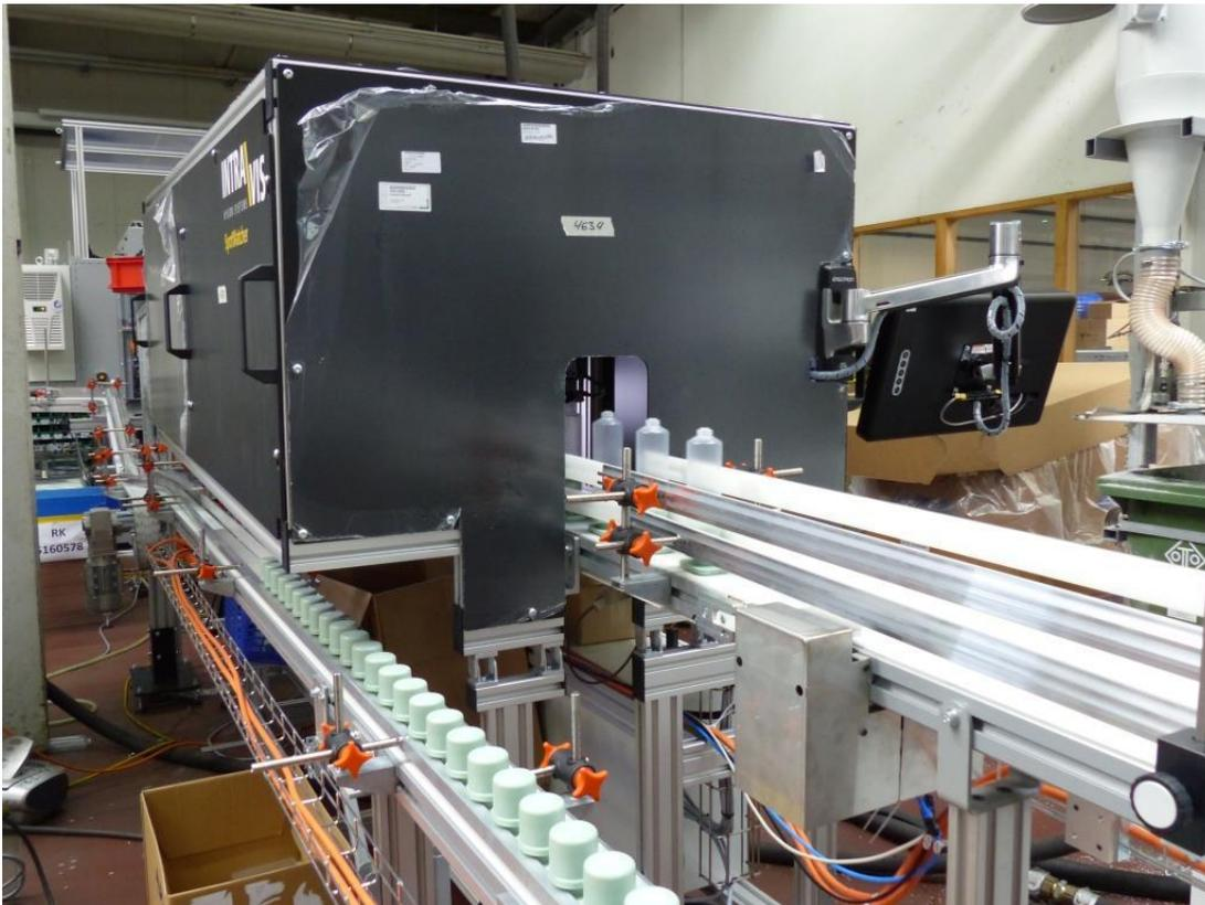
*Abbildung 3: Inline Kamerasystem zur optischen Prüfung der Tuben*
