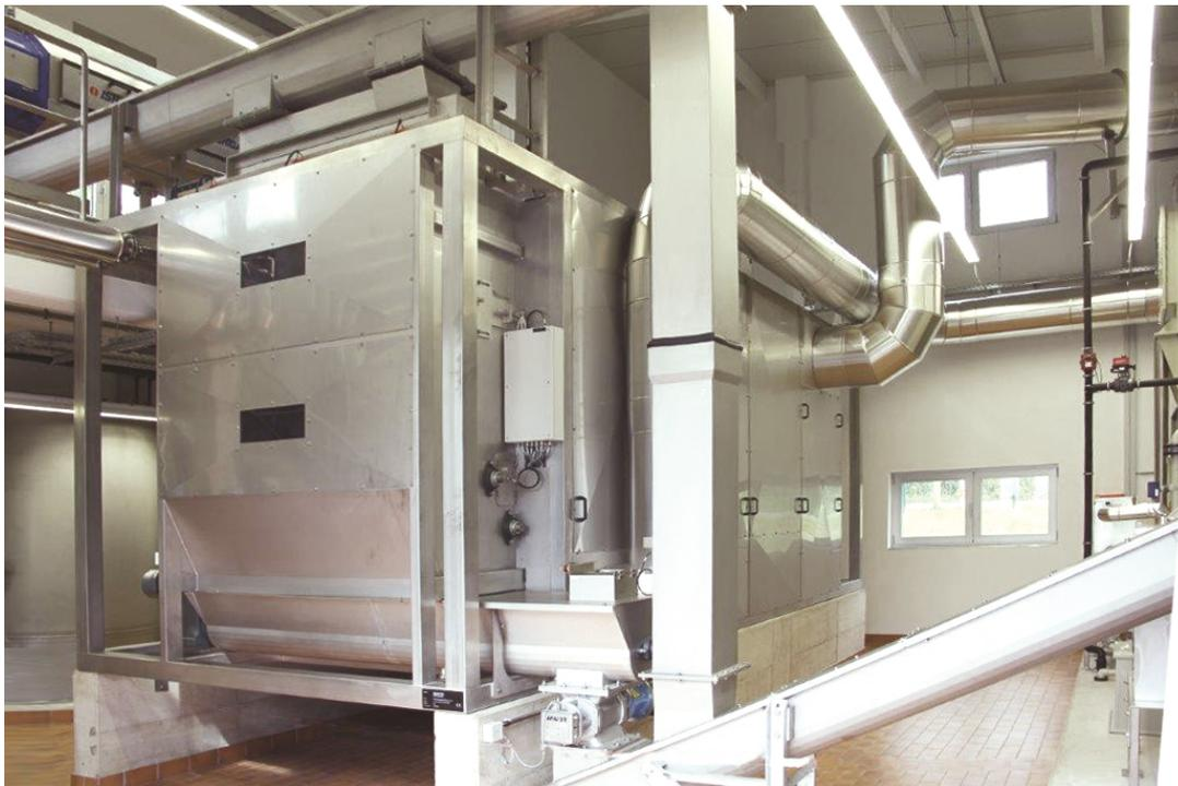
**Abb. 6: Foto des installierten Bandtrockners EloDry®**
