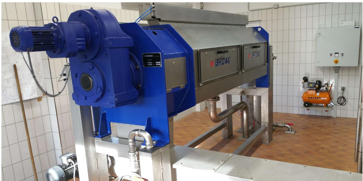
**Abb. 3: Foto der installierten Schneckenpresse IEA Typ SP-HF 05 XL**
