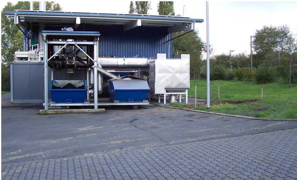
**Abb. 8: Foto der PYREG®-Anlage mit dahinter eingebaute Entwässerungs- und Trocknungsanlage**
